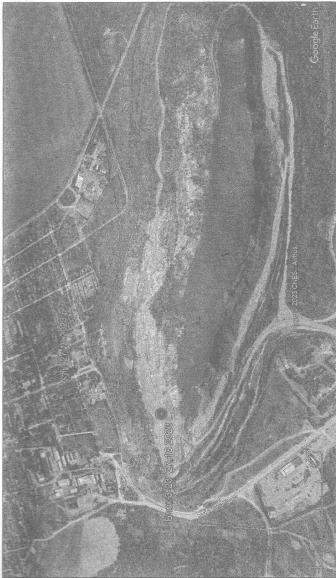
Рис.1 Точки встановлення цифрового сейсмографа BlastMate III з мікрофоном та трьохосовими геофонами та (або) сейсмостанції ZET 048-E з трьохкомпонентним акселерометром BC 1313 при моніторингу вібрації, а саме швидкості сейсмічних коливань ґрунту і надлишкового тиску на фронті ударної повітряної хвилі, та місце проведення масового вибуху.
