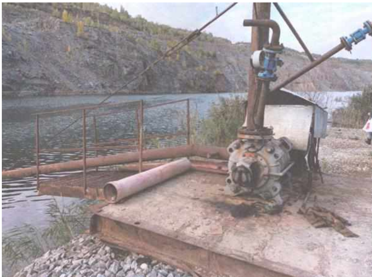
Рисунок 3.2 – Насосна станція для відкачування води з кар'єру
